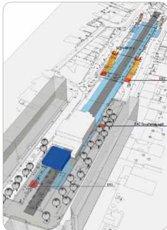
Aménagements pour améliorer la sécurité en cas d'évacuation de la gare de Vincennes.
