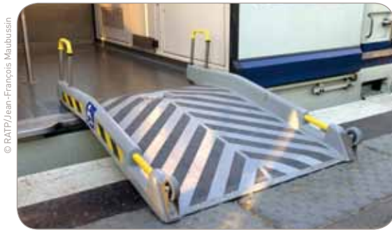
Mise en place d'une passerelle d'accès quai/train sur un train de type M184
