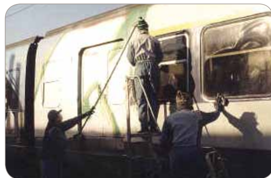
Nettoyage patrimonial d'un train de type MI84
